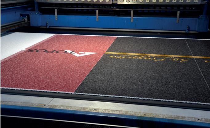
Aufwickeln der bedruckten Oberfläche
